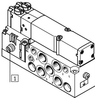
1 Elektrischer Anschluss, Stecker 4-polig, M8, nach EN 60947-5-2
