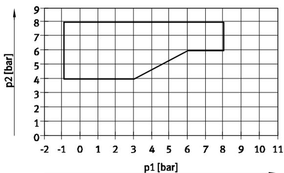
für Polymer-Sitzventil in Baubreite 10 mm mit Code: MU, NU, KU, HU
